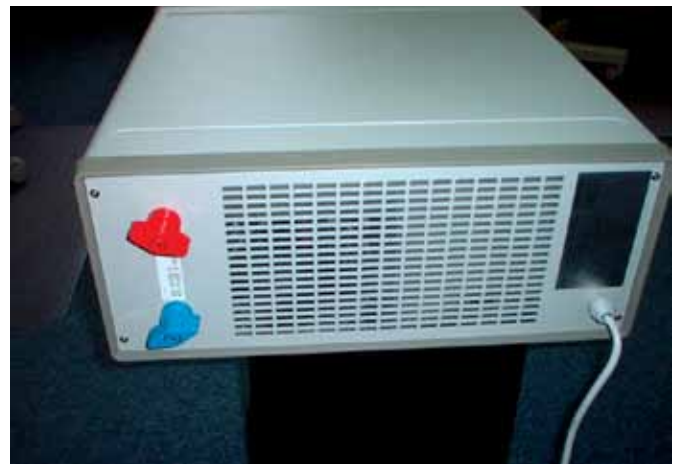
Hochstromklemmen auf der Rückseite (bis 70 A)
