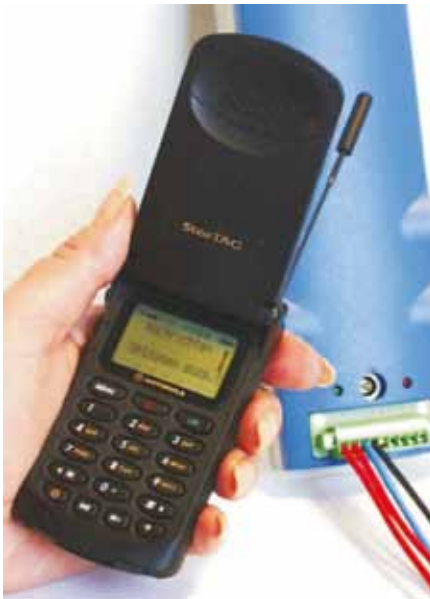
Schutzanlagensteuerung per Handy
