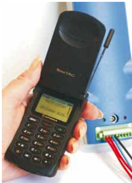
Schutzanlagensteuerung per Handy
