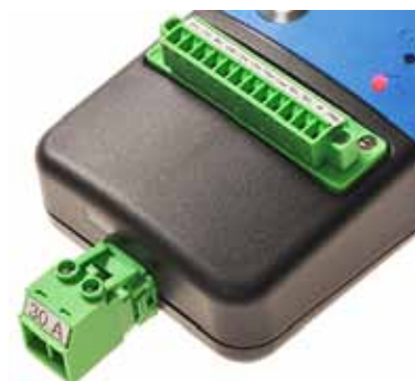
4 DC und 4 AC Kanäle 30 A zum Takten und für die Schutzanlagensteuerung
